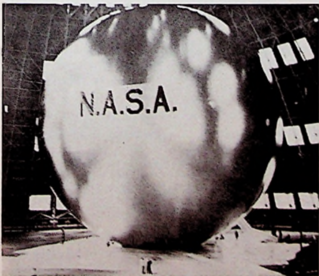
Afb. 4. De communicatiesatelliet „Echo 1”. Deze met gas gevulde plasticballon, voorzien van een dunne aluminium laag, reflecteert het ontvangen signaal naar de aarde terug. Het is dus een passieve satelliet.
