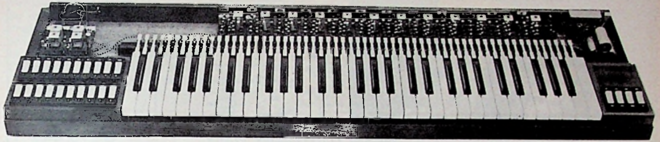
De 5-octaafs Organino zonder deksel: links het filter met schakelaars; rechts de voeding.
