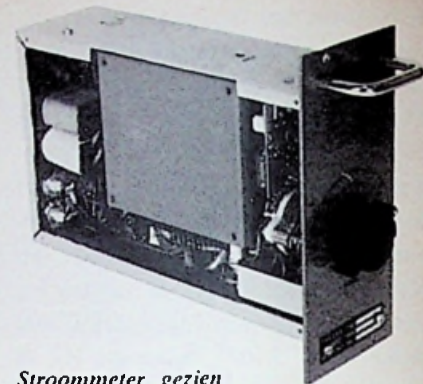
Stroommeter gezien van de andere zijde; links voedingstrafo en in- en uitgangsockets; in het midden: de Keithley op-amp.; rechts boven: de modulatieprint. De nulstellers- en bromcompensatiepotmeters zijn via gaten in de bovenzijde bereikbaar.
